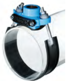
Objednáací číslo: 5003 + třmen • DN50 - 800 Materiál: Tvárná litina a nerez Těsnění: EPDM
