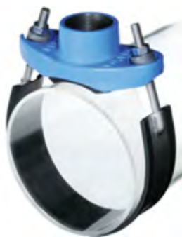
Objednáací číslo: 5002 + třmen • DN40 - 800 • PN10/16 Materiál: tvárná litina a nerez Těsnění: EPDM
