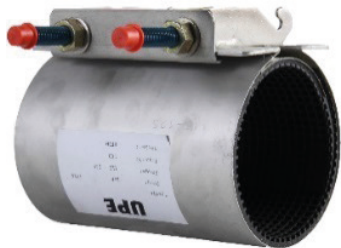
Objednací číslo: 7001 • DN60 - 300 Třmen opravný jednostranně upnutý Materiál: nerez Délky: 200 - 600mm Varianty s pákou: na poptávku
