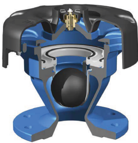
Objednací číslo: 10100 • DN2"-200 • PN10 - 25 Automatický odvzdušňovací a zavzdušňovací ventil VANNAIR V200 Protikoroziční ochrana: epoxid podle GSK (RAL2015) Materiál: GGG-50
