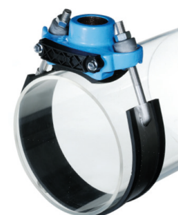
Objednací číslo: 5003 + třmen • DN50 - 800 Materiál: Tvárná litina a nerez Těsnění: EPDM
