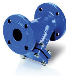
Objednací číslo: 10001 • DN50 - 400 • PN10 - 16 Přírubový filtr typ „Y“ Protikoroziční ochrana: epoxid podle GSK (RAL2015) Materiál: GGG-50
