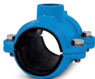
Objednací číslo: 5020 • DN32 - 300 Pas navrtávací na PE Materiál: tvárná litina Těsnění: EPDM
