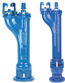
Objednací číslo: 9KJ / 9KD • DN80 - 100 • PN10/16 Hydrant podzemní Materiál: GGG-50 Vřeteno: nerez ocel
