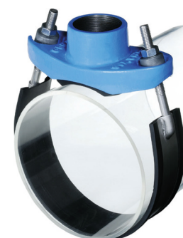
Objednací číslo: 5002 + třmen • DN40 - 800 • PN10/16 Materiál: tvárná litina a nerez Těsnění: EPDM
